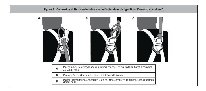
Connectez un dispositif de connexion approprié, soit un EAL ou une SRL en joignant l'extrémité du connecteur à l'anneau en D à l'extrémité de l'extendeur. Consultez les consignes du fabricant concernant l'usage adéquat du matériel. Voir figure 8.
