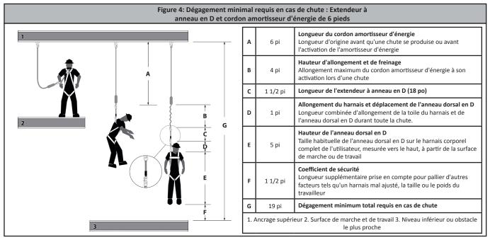
REMARQUE: L'utilisation d'un extendeur augmente la hauteur de chute potentielle de l'utilisateur. L'utilisateur doit s'assurer que la distance totale augmentée fasse partie du calcul des hauteurs de dégagement permises, incluant la chute balancée. Veuillez noter que lors de l'utilisation d'un SRL, il peut y avoir un dégagement supplémentaire dépendamment de l'endroit du point d'ancrage. En cas d'incertitude, consultez une personne compétente.
