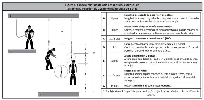
NOTA: El uso de un extensor aumentará la distancia potencial de caída de los usuarios. El usuario debe asegurarse de que la longitud total aumentada de una cuerda de seguridad se tenga en cuenta al calcular las distancias de separación de caída, incluida la caída de oscilación. Tenga en cuenta que al usar una SRL, puede haber espacio de caída adicional requerido según la ubicación del punto de anclaje. Si no está seguro, consulte a una persona competente.
