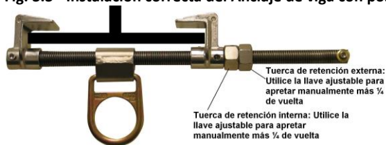
Fig. 3.4 Anclaje de viga con posición fija (7533 y 7534)
